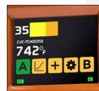
Die Artikel-Nr. der Lötspitze und deren Temperatur wird auf dem Display angezeigt
